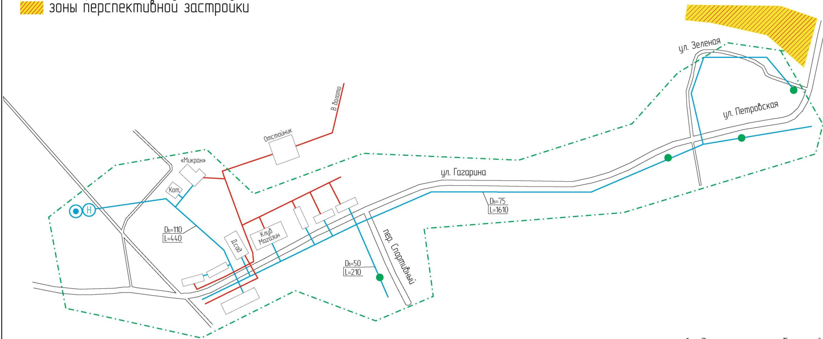
\* подключение потребителей к водопроводным сетям выполнено трубами D<sub>в</sub>=25
